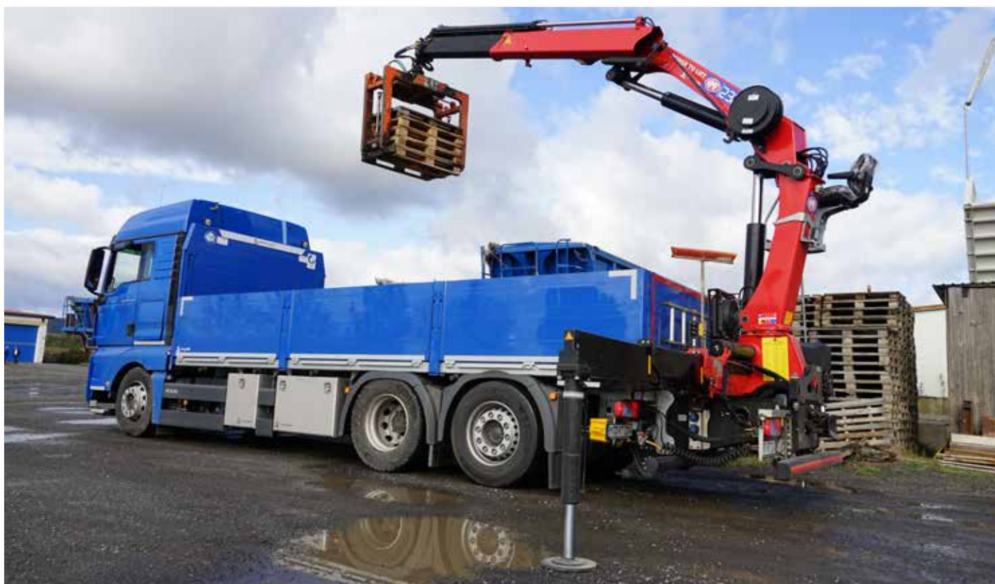
HMF 2320 Ladekran mit Unilock-Kran-Schnellwechselsystem. Der Knickarmkran ist auf einer hydraulisch abkoppelbaren Konsole montiert.
